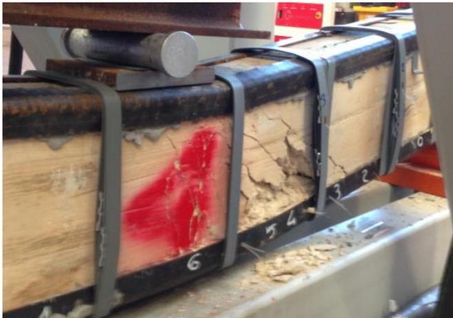
Figura 22. Cerniera plastica sviluppata nel tratto centrale a momento sollecitante costante dove è evidente lo sfruttamento dell'angolare del Sistema CAM<sup>®</sup>
