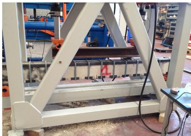
Figura 19. Prove a flessione sulle travi con carico su due punti, attrezzatura di prova.
