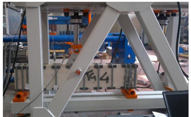
Figura 24. Configurazione di prova adottata per i test a taglio. Schema di carico di trave in appoggio-appoggio e carico concentrato centrale.
