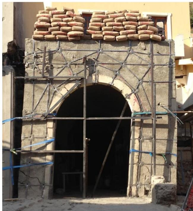
Figura 10. Arco già sottoposto a carico orizzontale ciclico senza rinforzo e successivamente rinforzato. Nelle due condizioni di prova è stato aggiunto un carico verticale atto a simulare lo scarico di un solaio o di una parete portata.
