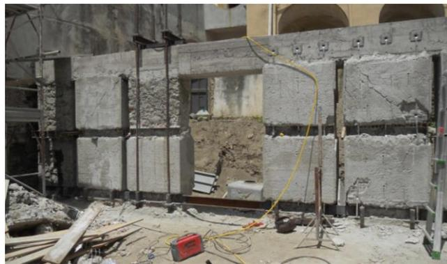
Figura 4. Preparazione dei pannelli e inizio prova shepard del pannello 2
