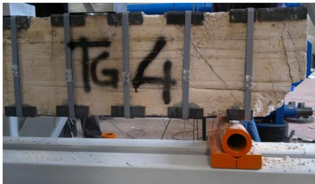
Figura 25. Stato fessurativo per trave rinforzata a tutta altezza. Prima fessura in zona di appoggio inclinata di circa 45°
