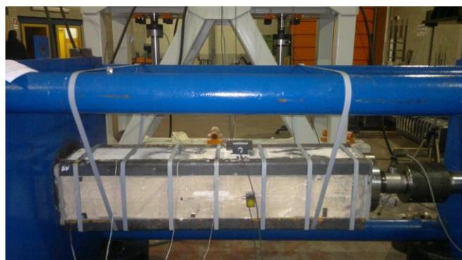
Figura 17. Prove di compressione sui pilastri, attrezzatura di prova.
