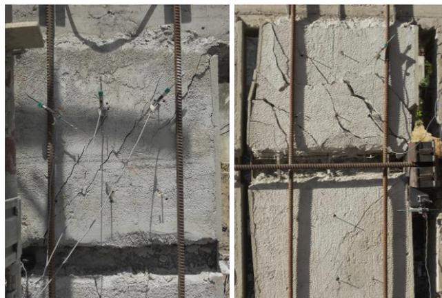
Figura 9. Confronto stato fessurativo tra pannello 2 non rinforzato ( a sinistra) e pannello 7 (a destra) rinforzato con CAM® ad alta resistenza
