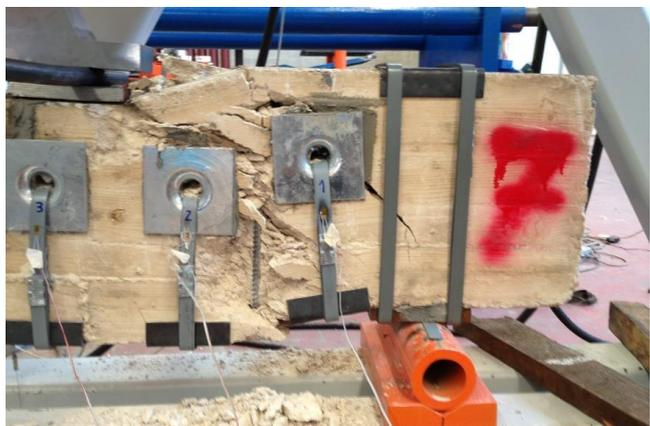
Figura 26. Situazione al collasso per trave rinforzata "sotto-solaio" avvenuta per rottura della biella compressa.
